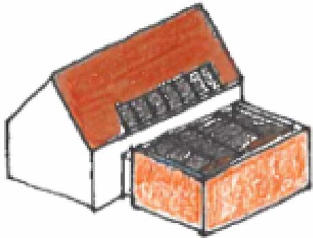
PV-Module in West-Ost Ausrichtung mit 10 ° und unter der Attika in Kombination mit „Traufenmodulen“
