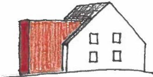
PV-Module vom Flachdach auf restl. Dachfläche erweitert. Restfläche mit gleichfarbigem Falzblech.
