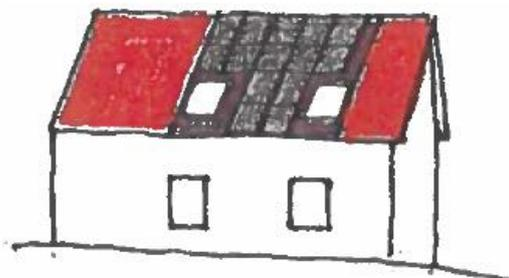
Ergänzung von Restfläche zwischen PV-Modul und Dacheinbauten mit gleichfarbigem Falzblech
